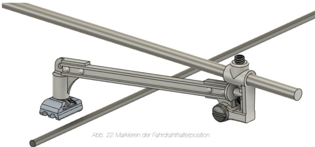
Abb. 22 Markieren der Fahrdrathalterposition
