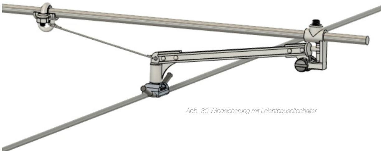
Abb. 30 Windsicherung mit Leichtbauseitenhalter
