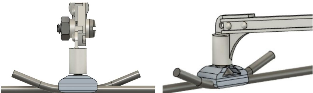
Abb. 27 Fahrdrabtmontage am Fahrdralthalter
