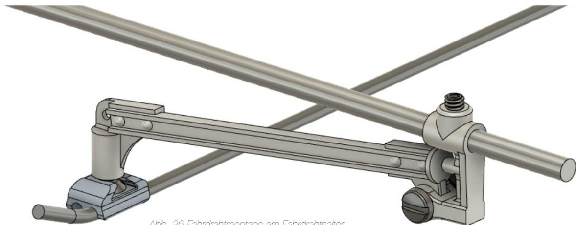
Abb. 26 Fahrdrabtmontage am Fahrdralthalter
