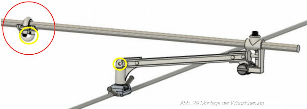
Abb. 29 Montage der Windsicherung
